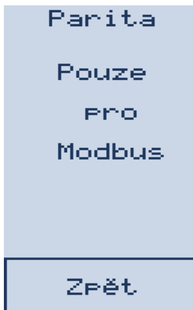
Obr. 49 – Obrazovka s nastavením parity v případě vybraného protokolu ARION
