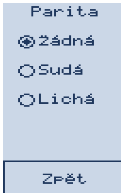
Obr. 48 – Obrazovka pro nastavení parity
