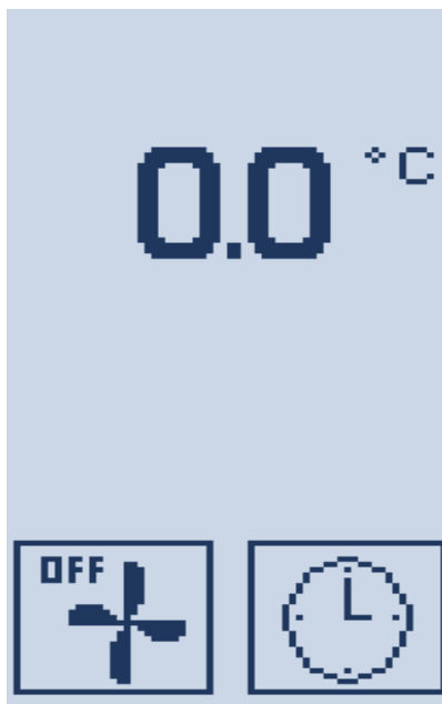
Obr. 28 – Obrazovka „Hlavní“ se statickým textem „°C“
