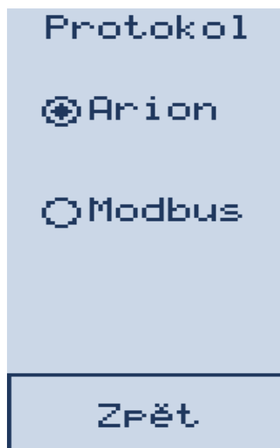
Obr. 39 – Obrazovka s nastavením volby komunikačního protokolu
