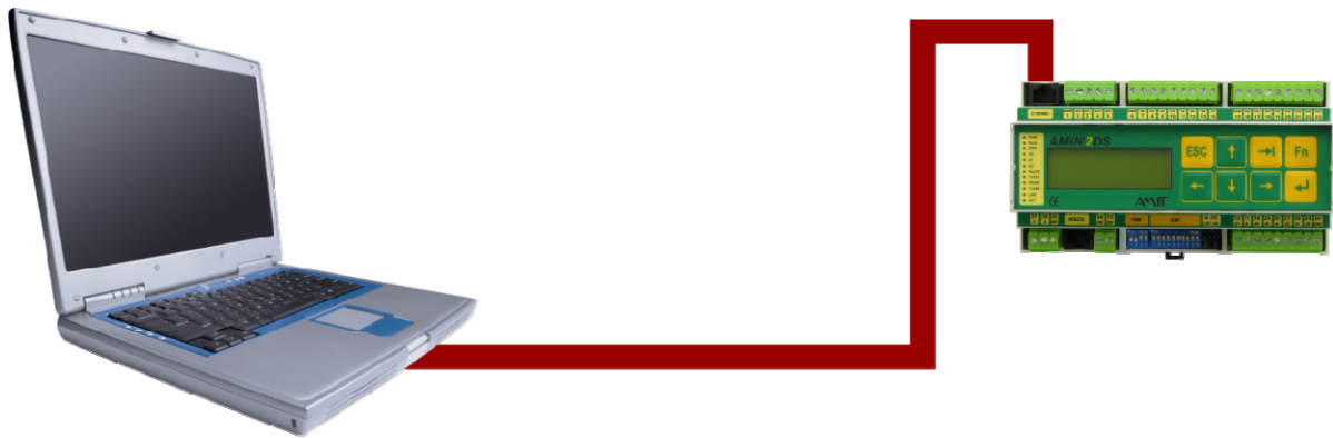
Obr. 1 - Přímé propojení PC s řídicím systémem
