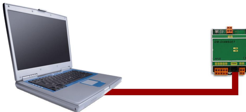
Obr. 3 – Přímé připojení k převodníku kříženým kabelem
